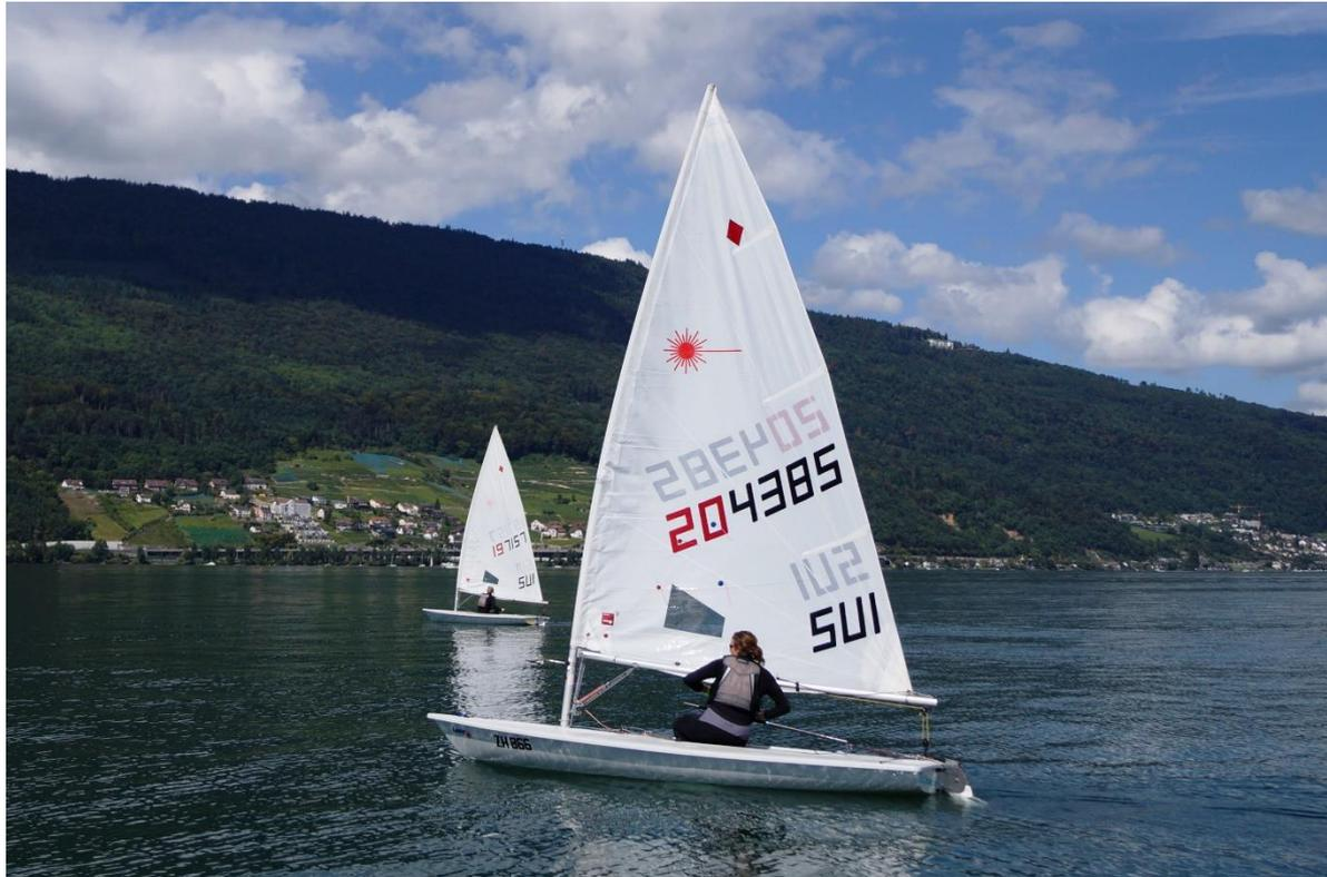
Verlagere dein Gewicht in die Mitte des Bootes und luvle langsam an. Die Pinne soll nicht weiter als bis zur Hälfte zwischen Cockpитеcke und Scheuerleiste gedrückt werden.
