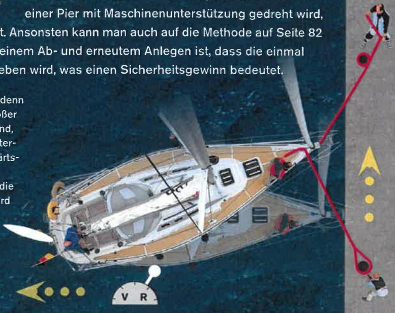
**3** Schritt 2 kann auch weitgehend entfallen, er dient in erster Linie der Entlastung des Bugbereiches. Ist die neue Vorspring ausgebracht, wird auch in diese wieder eingedampft. Dabei gleichzeitig die Spring dosiert so weit fieren, dass die Yacht wieder an ihrem Ursprungsplatz liegt.
