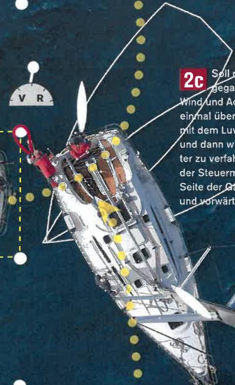
**2c** Soll mit dem Bug an den Steg gegangen werden, ist es bei viel Wind und Achterausfahrt sicherer, erst einmal über das Heck eine Verbindung mit dem Luv-Pfahl der Box herzustellen und dann wie auf Seite 33 gezeigt weiter zu verfahren. Bei wenig Wind könnte der Steuermann auch auf die rechte Seite der Gasse wechseln, aufstoppen und vorwärts in die Box fahren.
