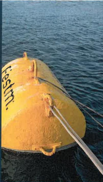
**2** Ganz in Ruhe kann jetzt eine Vorleine (gelb), die mindestens die zweieinhalbfache Schiffslänge haben muss, am Bug befestigt werden. Dazu die Leine außenbords nach achtern führen und auf Slip an der Ankerboje befestigen. Dafür wird nur eine Person benötigt.
