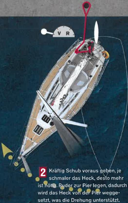
**2** Kräftig Schub voraus geben, je schmaler das Heck, desto mehr ist nötig. Ruder zur Pier legen, dadurch wird das Heck von der Pier weggesetzt, was die Drehung unterstützt.
