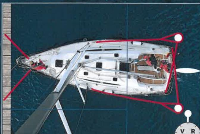
**4** Mittelsprings festsetzen, sie bleiben an den Pfählen als Sicherung nach achtern. Achterleinen über Kreuz ausbringen.
