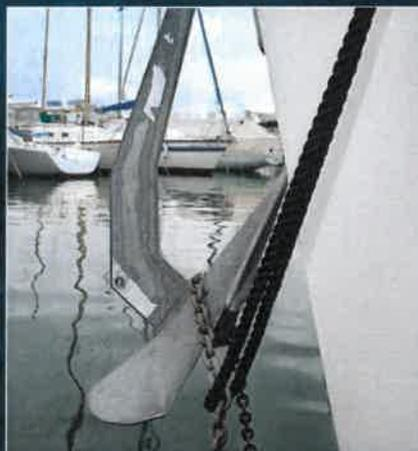
**2** Eine starke Leine oder einen Festmacher auf Slip um die Kette ziehen und durchsetzen, notfalls mit einer Winsch.
