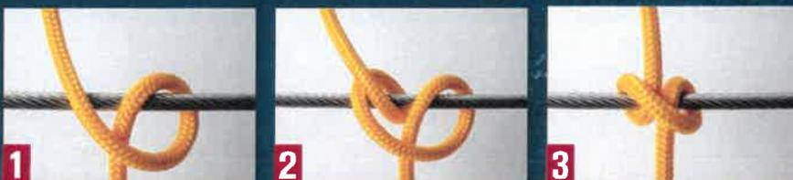
Den Tampen vom Körper weg von oben nach unten um den Draht führen, anschließend von unten nach oben, dabei den Tampen unter der entstandenen Bucht durchstecken.
