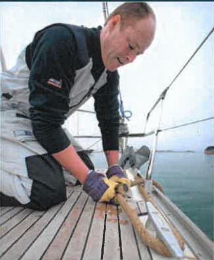
**7** Die Muringleine so schnell wie möglich sichern, durch Seitenwind oder Schwell können unhaltbare Kräfte entstehen.
