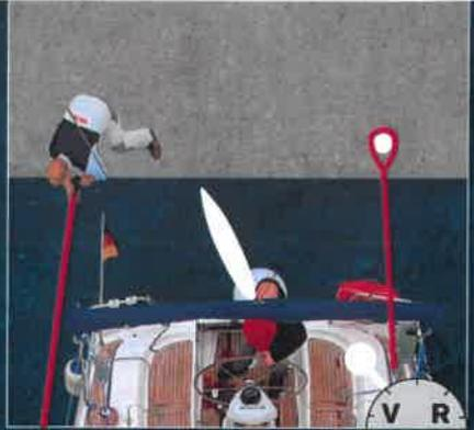
**3** Durch die Hebelwirkung am Heck wird der Bug nach Luv versetzt, bei Gegenruder auch das Heck.
