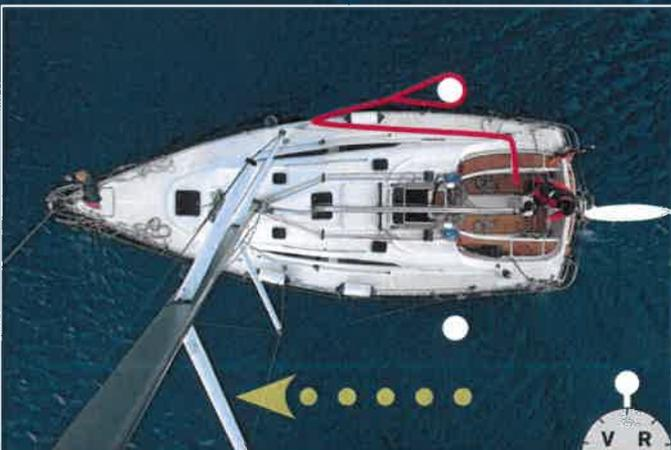
**2** Der Steuermann übernimmt die Mittelspring. Sobald die Mittelklampe die Pfähle passiert hat, holt er dicht. Die Yacht stoppt.
