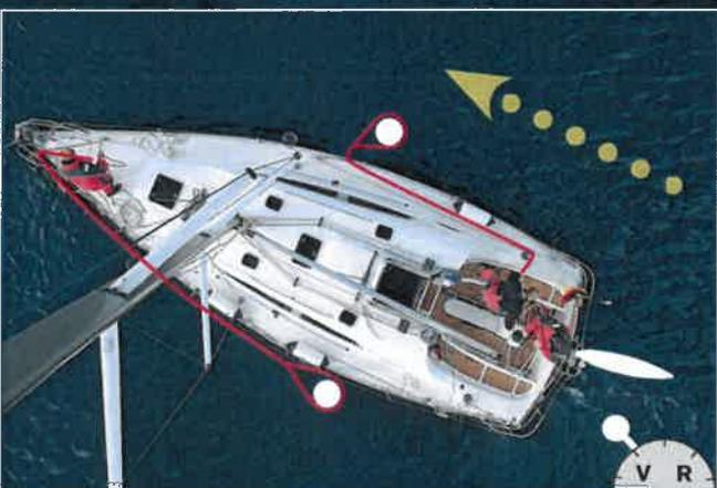
**3** Sobald die Lippklampe an Steuerbord den Pfahl passiert hat, wird die Mittelspring vom Steuermann kontrolliert gefiert.
