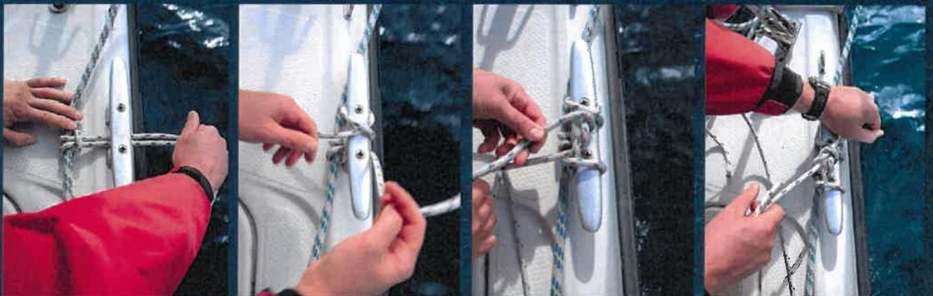
In eine starke Leine in die Mitte ein Auge knoten, die beiden Hälften an den Klampen entlangführen. Falls keine Springklampen vorhanden sind, auch die Genuaholepunkte verwenden. Mit kurzen Enden die Leine beibändseln, bei einem absehbar längeren Schlepp zum Beispiel mit Lappen gegen Schamfilen schützen. Auf den Winschen belegen.
