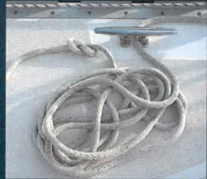
Mit dem Tampen einen halben Schlag um die feste Part fahren und den Tampen von hinten (!) durch das Auge stecken.
