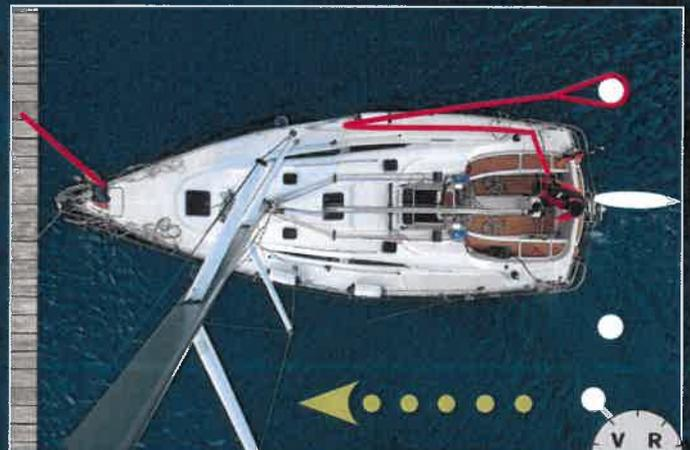
**3** Durch Fieren der Mittelspring die Yacht an den Steg führen. Der Vorschiffsmann bringt die Luv-Vorleine aus.
