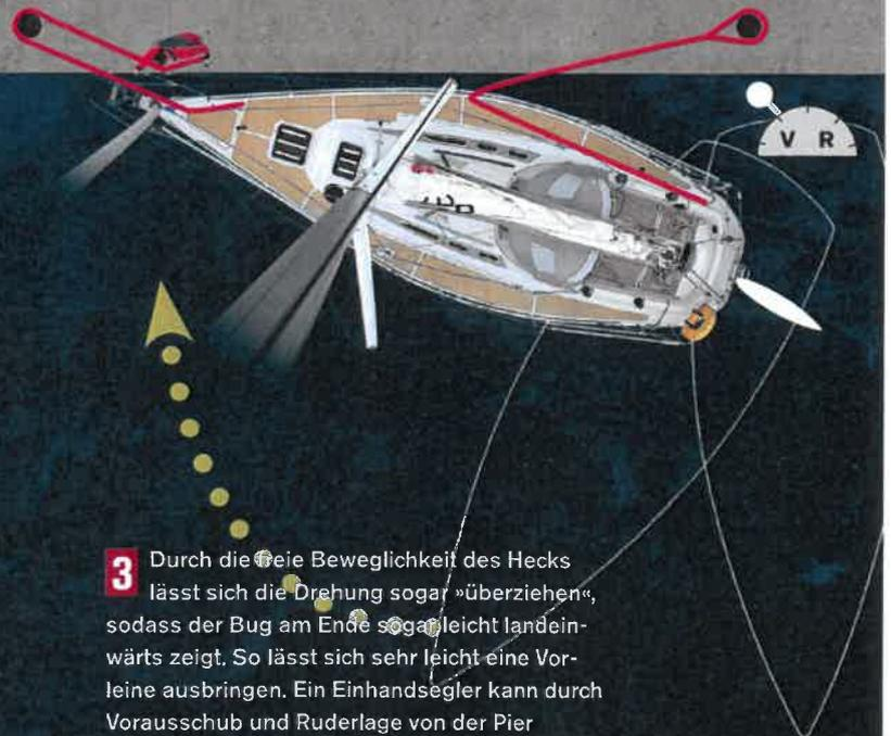
**3** Durch die freie Beweglichkeit des Hecks lässt sich die Drehung sogar »überziehen«, sodass der Bug am Ende sogar leicht landeinwärts zeigt. So lässt sich sehr leicht eine Vorleine ausbringen. Ein Einhandsegler kann durch Vorausschub und Ruderlage von der Pier weg die Yacht so fixieren, dass er ohne fremde Hilfe die restlichen Leinen ausbringen kann.
