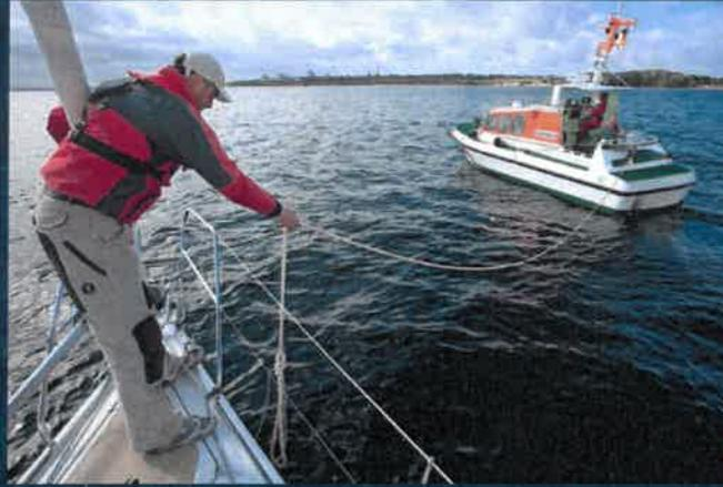
**4** Als Schlepper immer schräg voraus anfahren, um hartes Einrücken zu vermeiden. Die Trosse so lange mitführen, bis sie gespannt ist, dann das Vorschiff verlassen.
