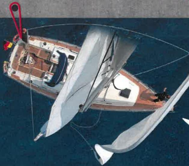
**1** Die Genua setzen; wenn der Wind etwas vorlicher als querab einfällt, auch das Groß. Leinen los. Der Bug schwingt normalerweise schneller nach Lee als das Heck. Heck abfendern. Segel langsam dicht holen. Liegen jedoch noch andere Yachten voraus am Steg, sollte eine Achterleine auf Slip ausgebracht werden. Dann kann die Yacht nicht unkontrolliert Fahrt voraus aufnehmen.
