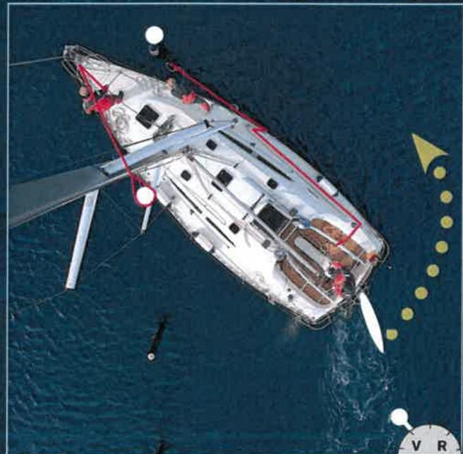
**2** Sobald der Bug den Pfahl passiert hat, die Vorspring wieder langsam fieren. Den Bootsrumf am Backbord-Pfahl abfendern. Nun eine Mittelspring an Steuerbord ausbringen und kontrolliert dicht holen (es geht auch mit einer Vorspring, S. 33).
