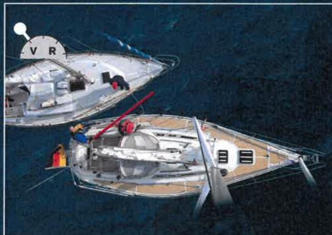
**2** Die Vorspring des Schleppers wird am Heck des Havaristen belegt. Diese Verbindung überträgt den Schub des Schleppers, er kann sich auch kontrolliert durch Eindampfen nähern.
