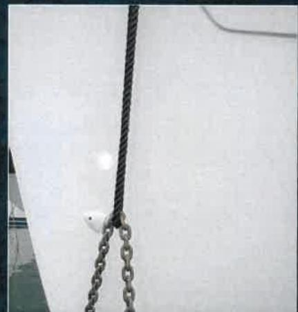
**3** Den eigenen Anker fieren. Er kann aus der Kette herausrutschen, da diese fixiert ist. Sie wird anschließend freigegeben.
