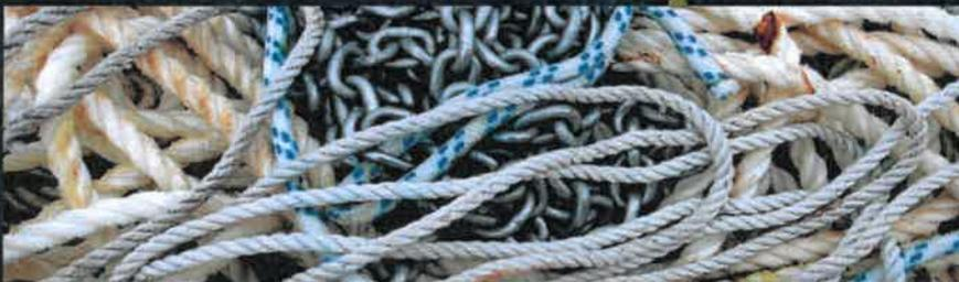
Am besten für den Halt des Ankers ist eine Kombination aus Kette und Trosse. Damit werden die Stärken beider Systeme kombiniert und die Schwächen so weit wie möglich getilgt. Eine Kette ist widerstandsfähig gegen mechanische Beschädigung durch Steine oder Korallen, ihr Gewicht sorgt für einen günstigen Anstellwinkel des
