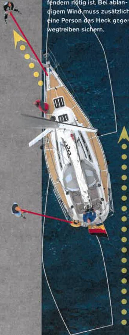
Eine Variante vor allem für Einhandsegler. Die Yacht wird abwechselnd über Vorleine und Achterspring vom Cockpit aus über die Winschen bewegt. Bei ablandigem Wind wird dabei durch die Abdrift ein leichter Bogen entstehen.
