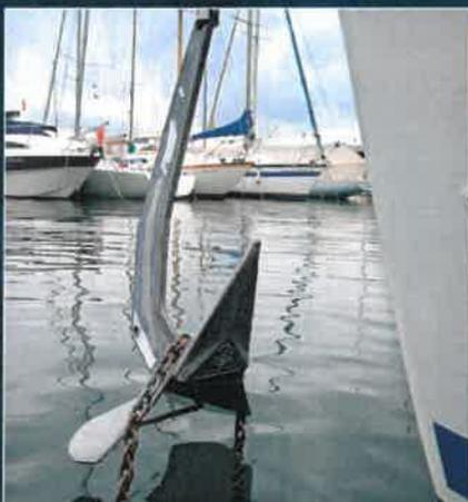
**1** Den Anker so weit aufholen, dass die fremde Kette erreichbar ist. Zur Not für Schritt 2 bis zu ihr tauchen.
