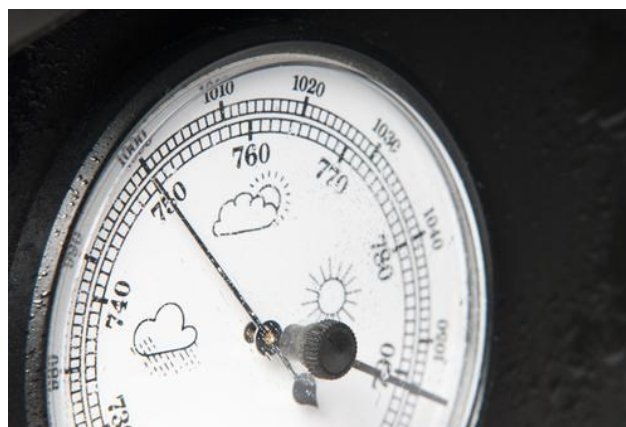
Mit einem Barometer lässt sich der Luftdruck messen.
