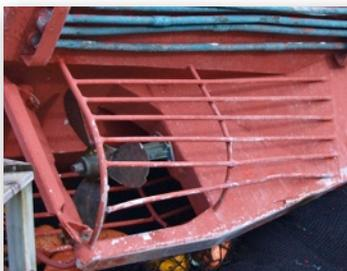
Um den Antrieb vor Eis zu schützen, sind am Markt diverse Konstruktionen zur Montage um den Propeller erhältlich. Da ihr Einsatz aber nicht unproblematisch ist - kleinere Eisstücke können sich zwischen Schutzkäfig und
